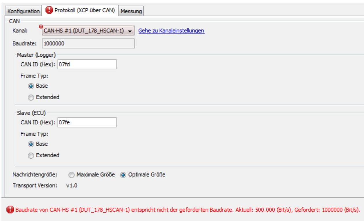
**Abbildung 6.27: Fehlermeldung aufgrund unterschiedlicher Baudraten**
