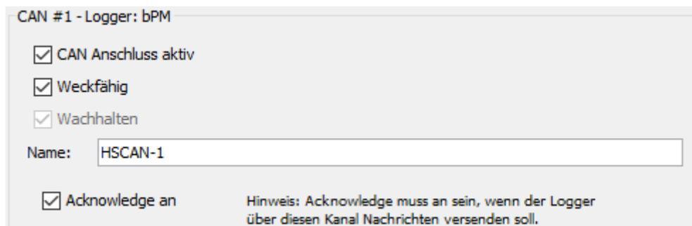
Abbildung 6.24: CAN Anschluss aktiv und Acknowledge an
