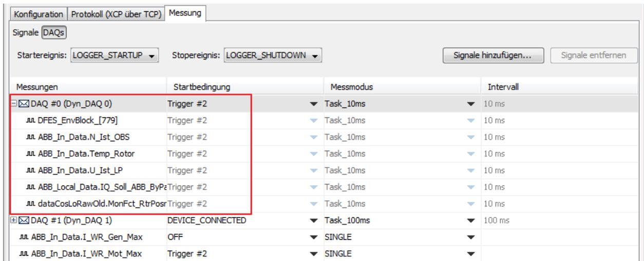
Abbildung 6.37: gleiche Startbedingung innerhalb einer DAQs-Liste
