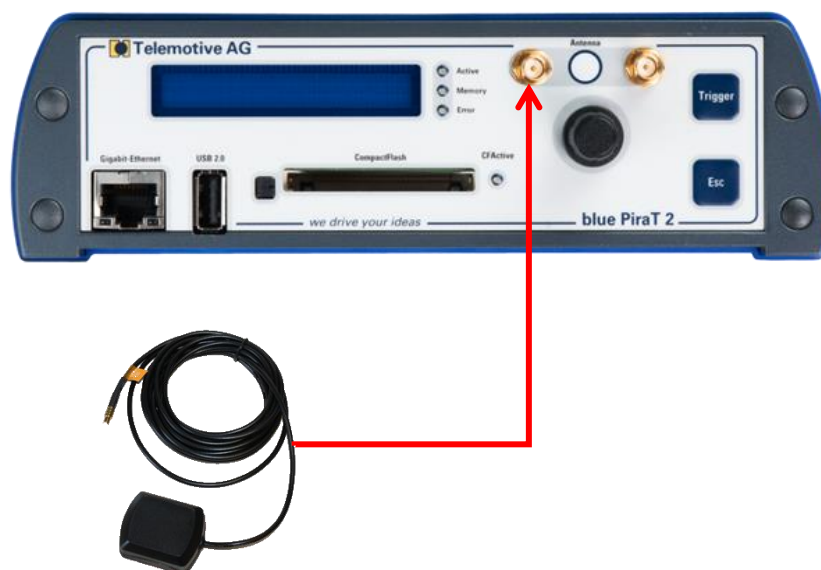
Abbildung 4.1: Anschließen der Antenne für interne GPS Module (nur bP2)
