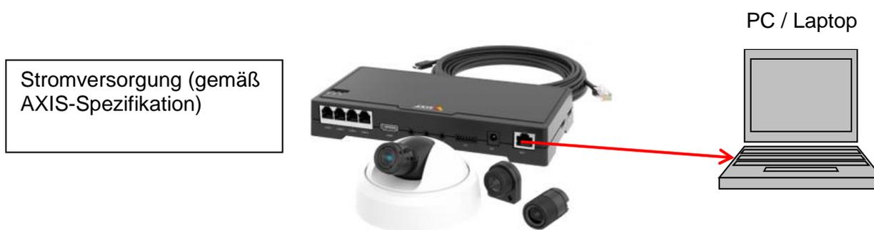
Abbildung 5.1: Anschließen der Netzwerkkamera an einen PC/ Laptop
