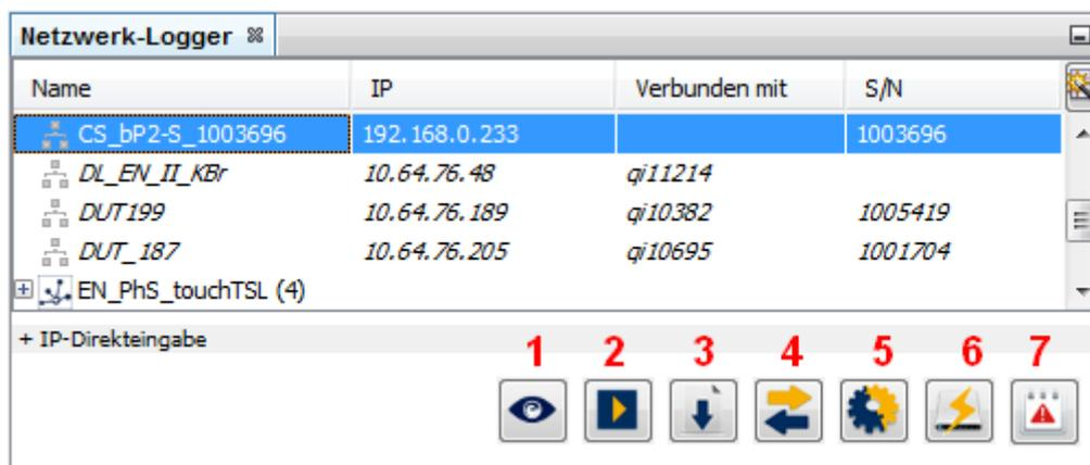
Abbildung 14.1: Auswählen eines Datenloggers im System Client
