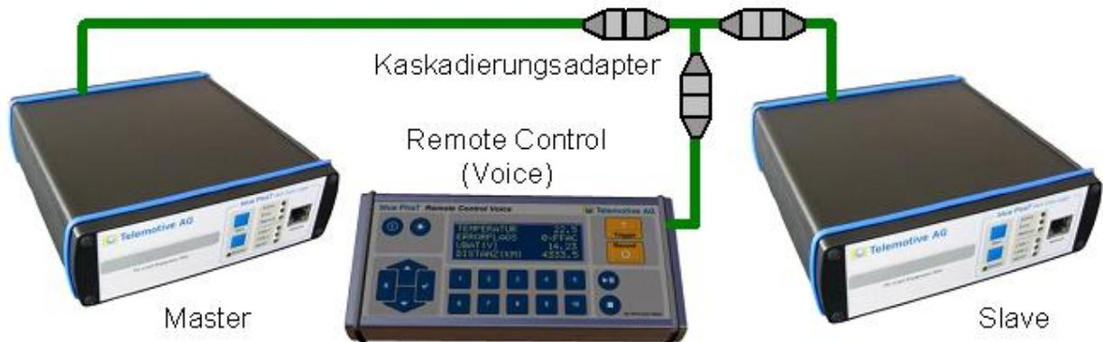
**Abbildung 5.2: Anschluss der RCV mit Kaskadierungsadapter**
