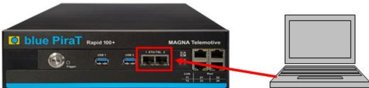
Abbildung 5.3: BLUEPIRAT Rapid – Verbindung zum Computer
