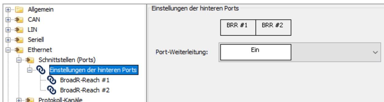
Abbildung 8.85: BroadR-Reach – loggen eines Kanals, Portweiterleitung: EIN
