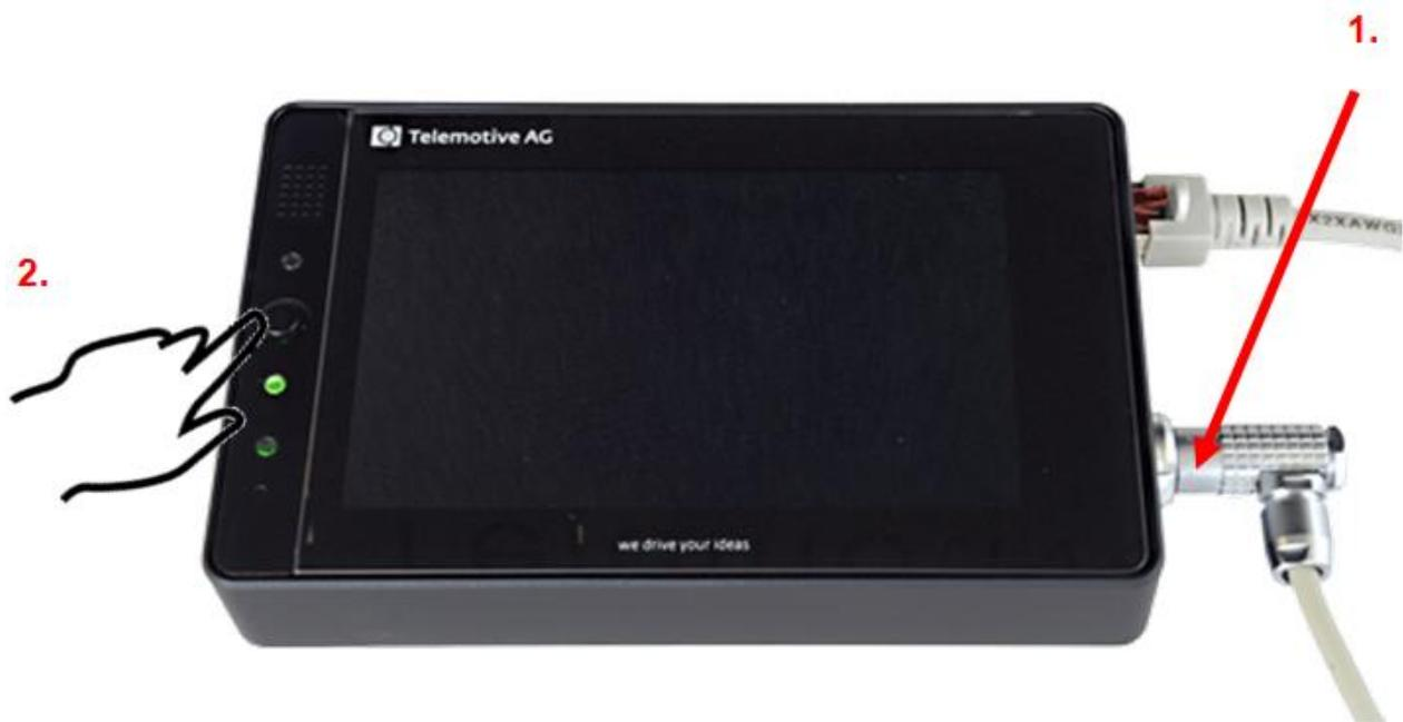
Abbildung 5.7: Einschalten der Remote Control Touch
