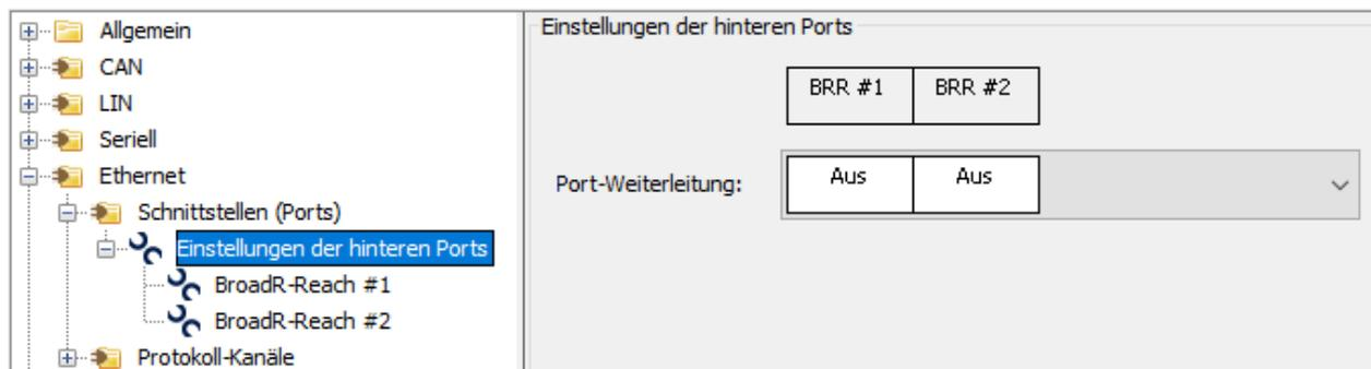
Abbildung 8.87: BroadR-Reach – loggen von zwei Kanälen, Portweiterleitung: AUS
