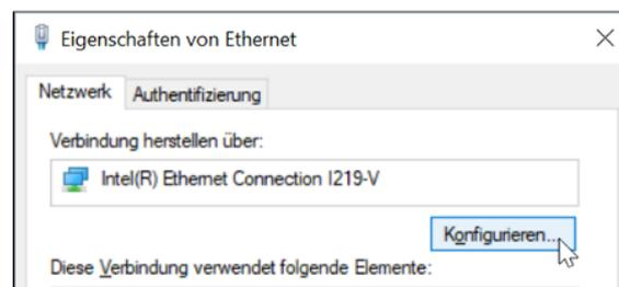
Abbildung 14.1: Konfigurieren der ETH Schnittstelle
