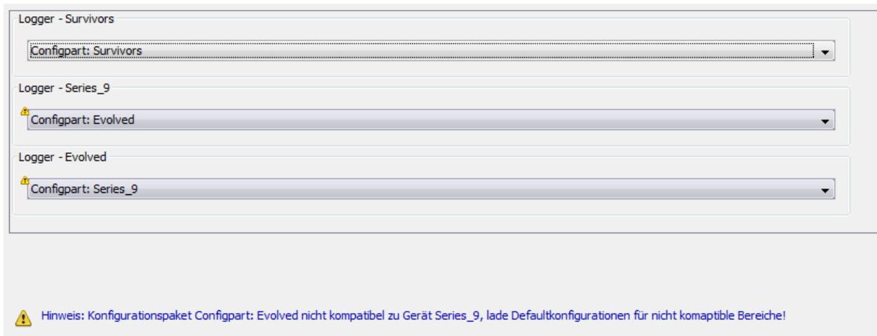
**Abbildung 9.23: Hinweismeldung zur Inkompatibilität von Gerät und Konfigurationspaket**
