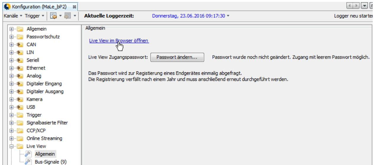
**Abbildung 11.3: Öffnen des Live View über die Konfiguration**
