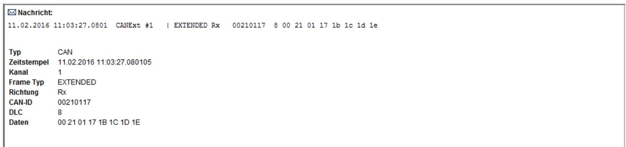
Abbildung 13.19: Nachrichtendetails einer CAN Nachricht
