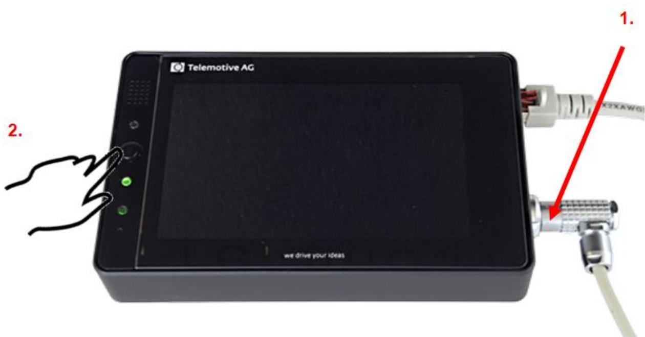
Abbildung 5.8: Einschalten der Remote Control Touch
