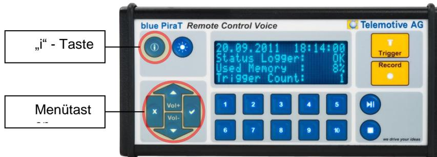
Das Gerät zeigt den Status von bis zu 4 Steuergeräten an.
