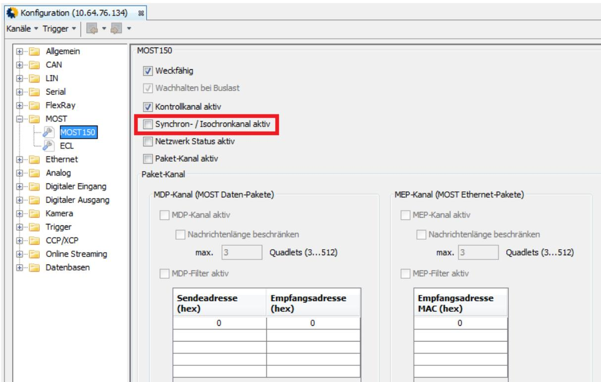
Vor der Aufzeichnung von MOST150 Synchron/Isochron Daten muss dieses Feature aktiviert werden. Die Aktivierung erfolgt durch die Markierung der Option **[Synchron- / Isochronkanal aktiv]** im Abschnitt **[MOST] => [MOST150]** des Konfigurationsbaumes.
