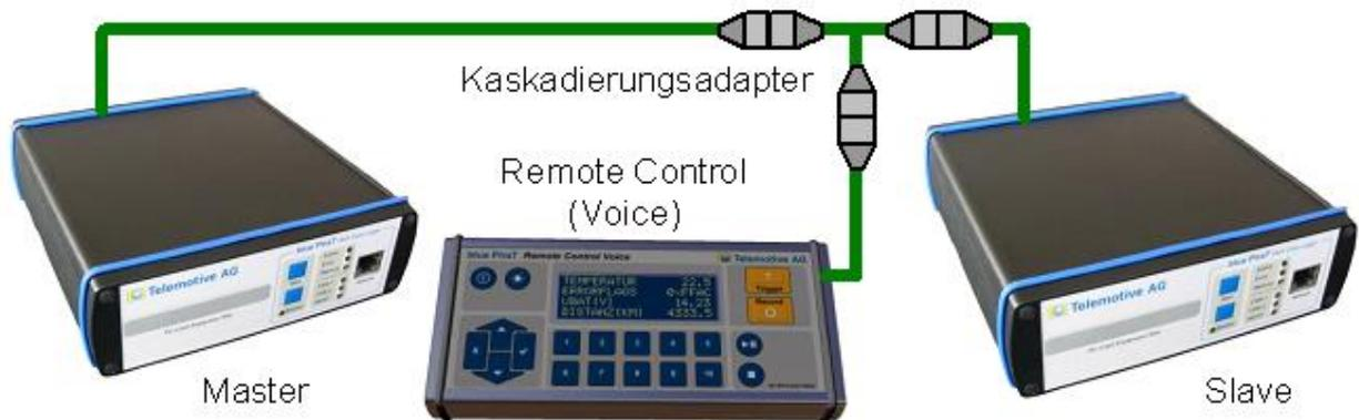
Abbildung 4.2: Anschluss der blue PiraT Remote Control Voice mit Kaskadierungsadapter
