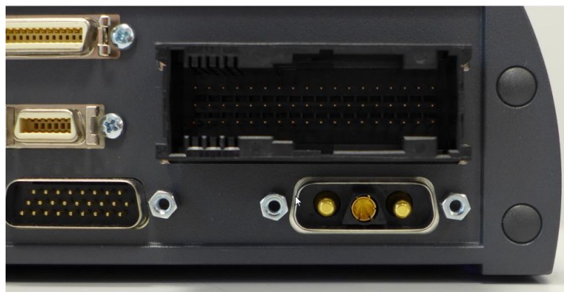
Abbildung 7.10: neuer verpolungssicherer Netzanschluss
