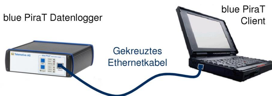
Abbildung 19: Anschluss eines Laptops an den Datenlogger
