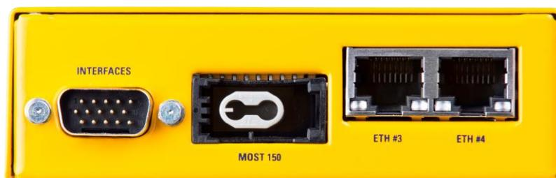
**Abbildung 6.3: Rückseite eines blue PiraT Mini MOST**
