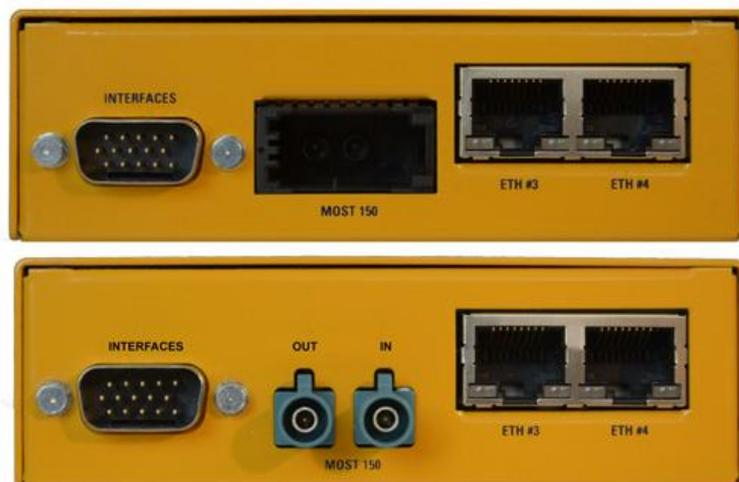
Abbildung 6.3: Rückseite eines BLUEPIRAT Mini MOST150 / MOST150 cPhy (Simplex / Duplex)
