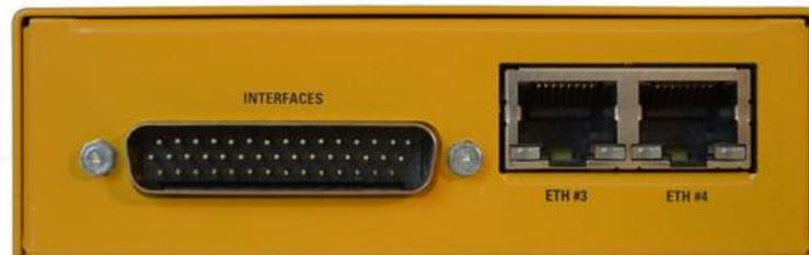
Abbildung 6.2: Rückseite des BLUEPIRAT Mini 8 CAN / 4CAN-FD / 8 LIN / FlexRay / 20 LIN
