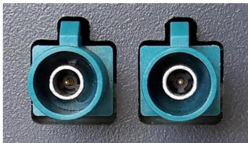
Abbildung 15.4: MOST150 cPhy Anschluss, elektrisch Simplex / Duplex
