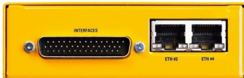
Figure 6.2: Rear side of the blue PiraT Mini CAN / LIN / FlexRay
